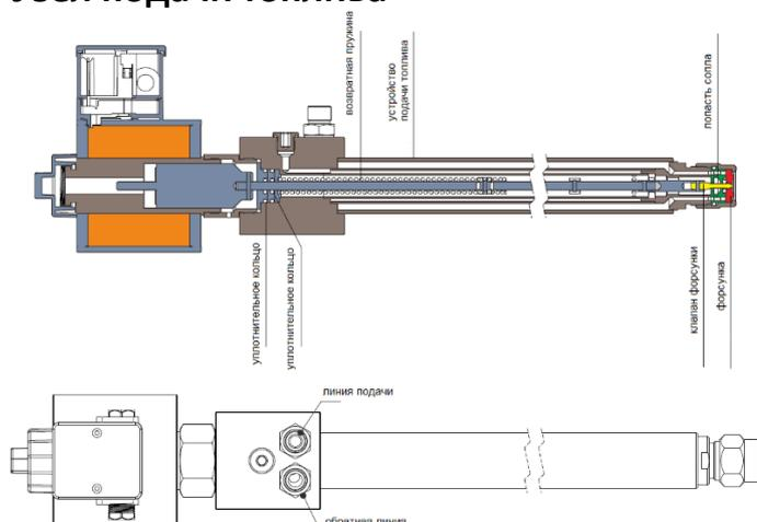
Открытие клапана форсунки контролируется рабочим жидкотопливным клапаном. Когда клапан находится под напряжением, создается электромагнитное поле, которое тянет шток, чтобы открыть форсунку и подать топливо. Когда клапан отключается шток при помощи возвратной пружины перекрывает подачу топлива. Уплотнительные материалы узла выполнены из фторкаучука. При возникновении утечки топлива необходимо заменить уплотнительные материалы, указанные на схеме.
