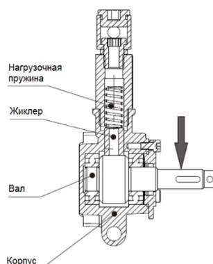
В момент, когда сервопривод открыт на угол  $0^\circ$  топливный клапан полностью открыт. Максимальный расход топлива в обратной линии достигается при открытии сервопривода на  $10^\circ$ , при этом расход на форсунку минимален (минимальная нагрузка). При открытии сервопривода на  $110^\circ$  топливный клапан закрыт, расход газа в обратной линии минимален, а мощность горелки максимальна.
