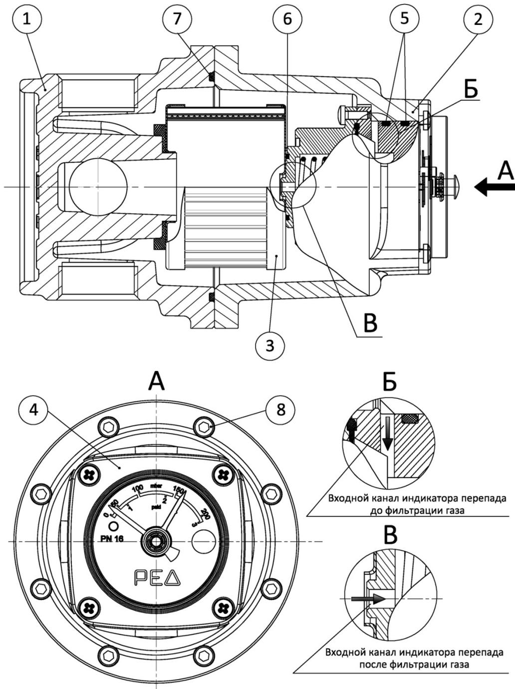
1 – корпус; 2 – крышка; 3 – фильтрующий элемент; 4 – индикатор перепада; 5 – кольцо уплотнительное; 6 – кольцо уплотнительное; 7 – кольцо уплотнительное; 8 – винт.
