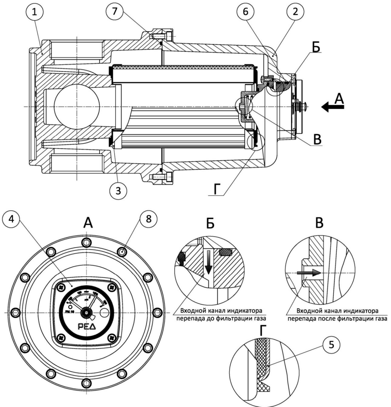
1 – корпус; 2 – крышка; 3 – фильтрующий элемент; 4 – индикатор перепада; 5 – шайба прижимная; 6 – кольцо уплотнительное; 7 – кольцо уплотнительное; 8 – винт.
