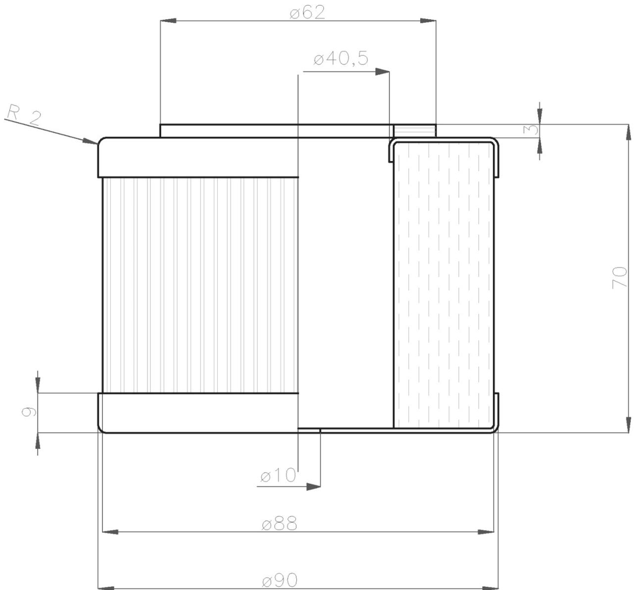
Рисунок 2 – Габаритные размеры фильтрующего элемента фильтра «РЕД-40»
