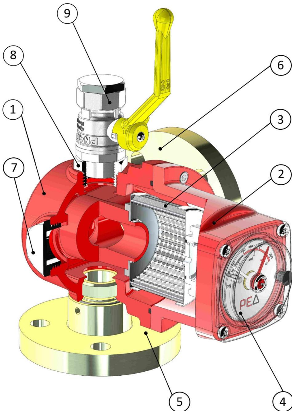
1 – корпус; 2 – крышка; 3 – фильтрующий элемент; 4 – индикатор перепада; 5 – фланец свободный на входе; 6 – фланец свободный на выходе; 7 – заглушка; 8 – футорка; 9 – кран шаровый G3/4” продувочный(по заказу).
