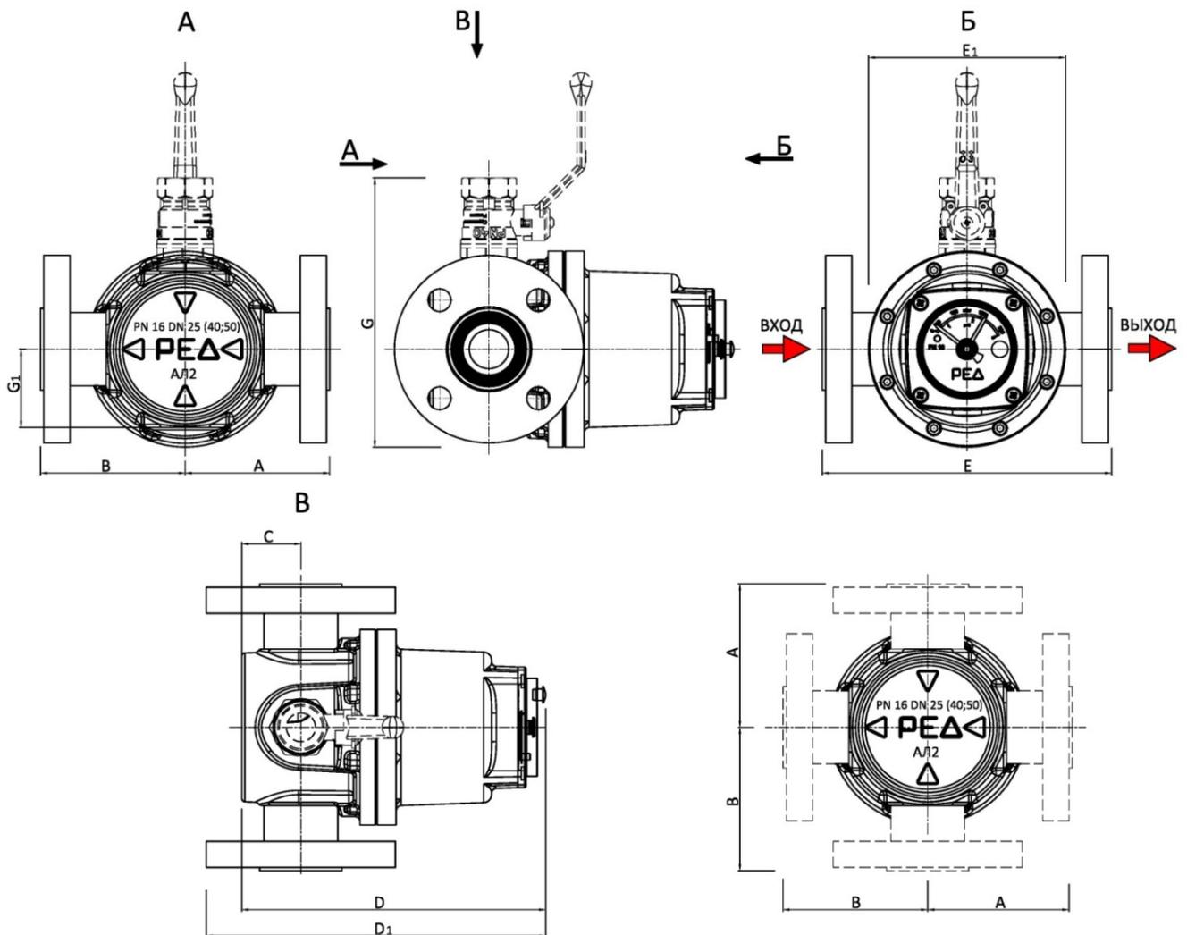
Рисунок 2 – Габаритные размеры фильтров газовых «РЕД-25 (40; 50)»
