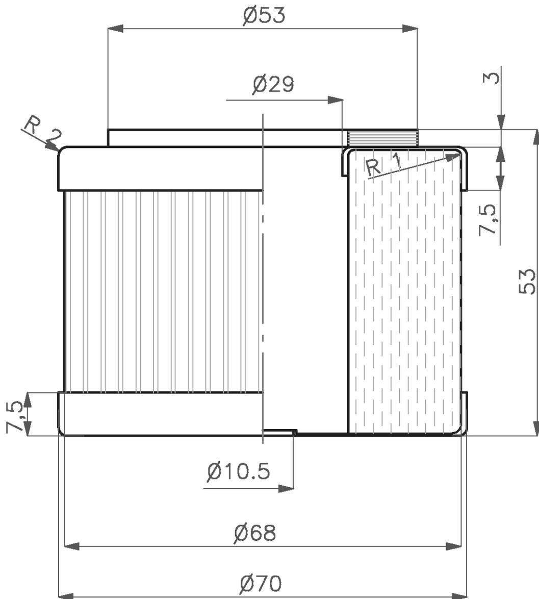
Рисунок 1 – Габаритные размеры фильтрующего элемента фильтра «РЕД-25»
