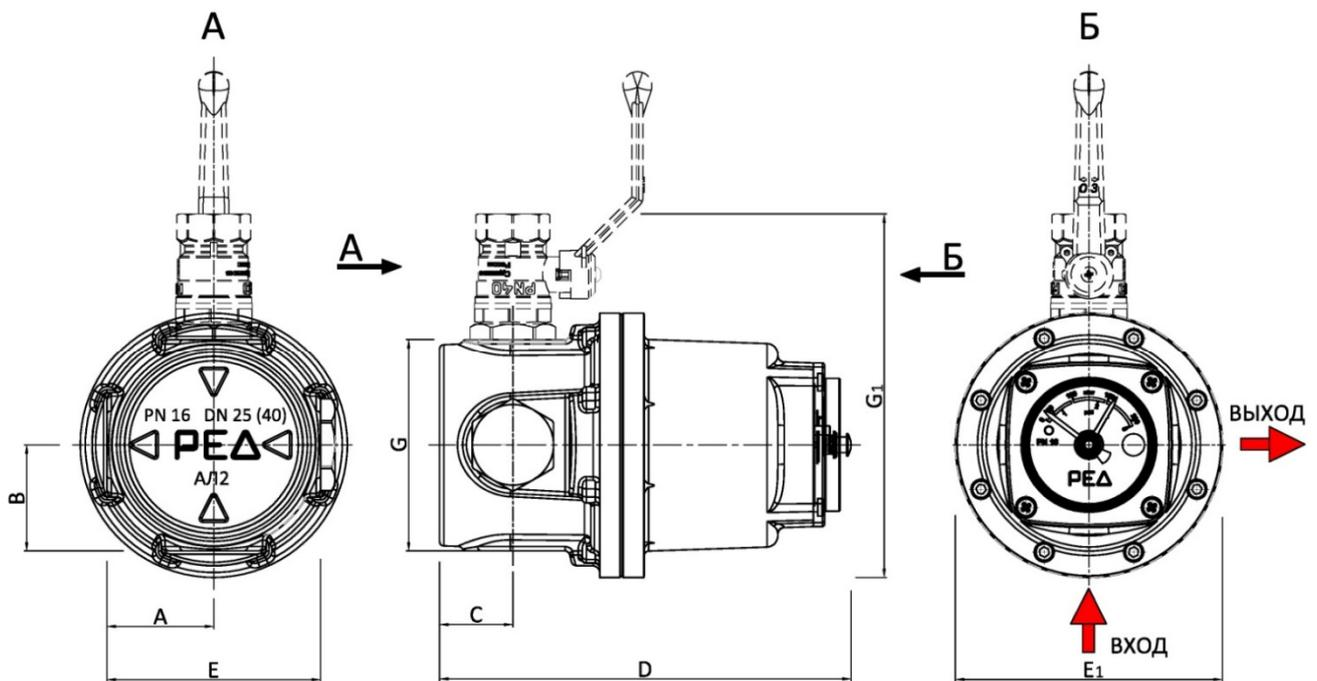
Рисунок 1 – Габаритные размеры фильтров газовых «РЕД-25 (40; 50)»
