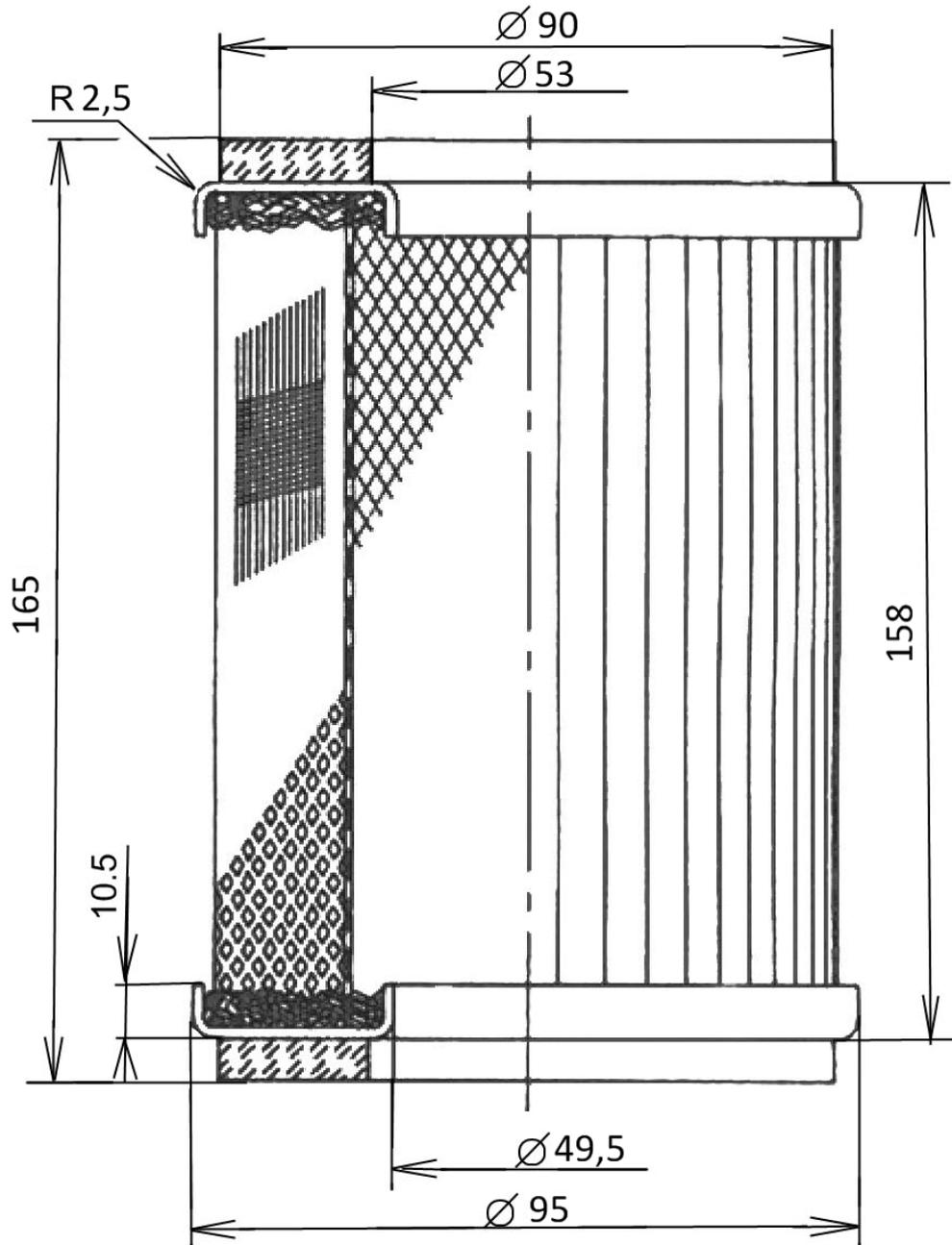
Рисунок 3 – Габаритные размеры фильтрующего элемента фильтра «РЕД-50»
